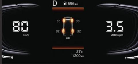
Cảm biến áp suất lốp (TPMS)
